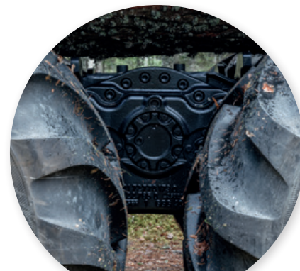
Pont moteur 40 km/h (débrayable)
