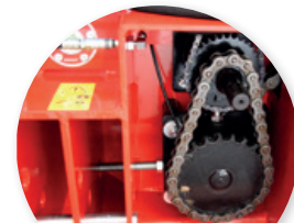
Graissage simplifié des chaînes de transmission
