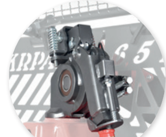
Assistance hydraulique au déroulement
